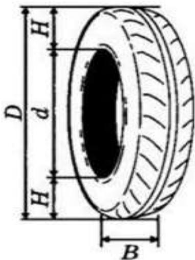
Задача об автомобильной шине. На автомобильной шине с помощью специальной маркировки указаны её размеры. Например, 265/60R18. Первое число означает ширину шины  $B$  в миллиметрах (см. рис.). Второе число означает отношение высоты профиля шины  $H$  к ширине шины в процентах. Буква означает конструкцию шины ( $R$  — радиальный тип), а последнее число означает диаметр обода колеса  $d$  в дюймах.
