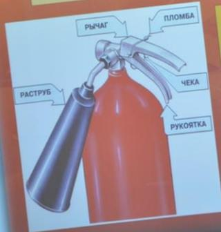
Углекислотные огнетушители предназначены для тушения загораний различных веществ и материалов, а также электроустановок, находящихся под напряжением до 1000 В
